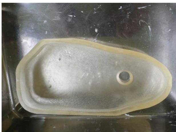
写真3 3Dプリンターで作成した注型
