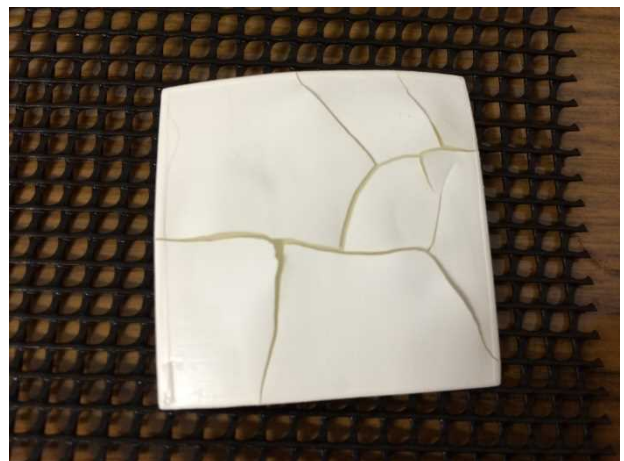
図5 プラモデル用塗料で塗装した試料を水に浸漬した際のひび割れた様子
