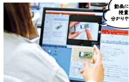
はんだ付けが不要で、手軽に電子回路を組み立てることができるブレッドボード
