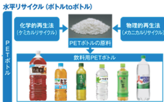
図-参 10-1 ペットボトルの水平リサイクル 出典 PET ボトルリサイクル推進協議会
