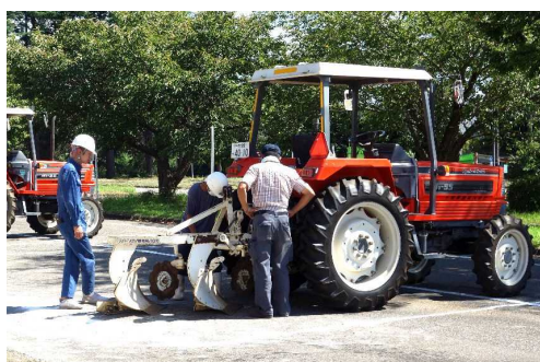
プラウ(作業機)の着脱練習
