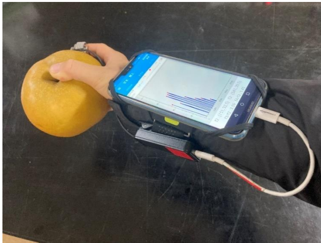
写真3 1点式振動硬度計によるのみつ症判別の様子
