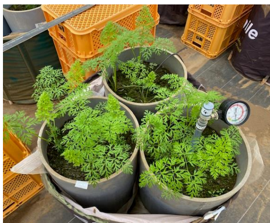
図1 湛水処理装置
