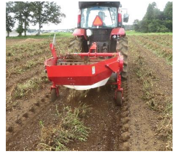
写真3 ラッカセイ掘取機
