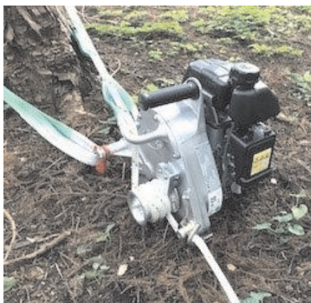
写真1 ポータブルロープウインチ ポリエステル製のロープを使用してけん引する搬出器具。スリングベルトで樹木に固定して使用する。
