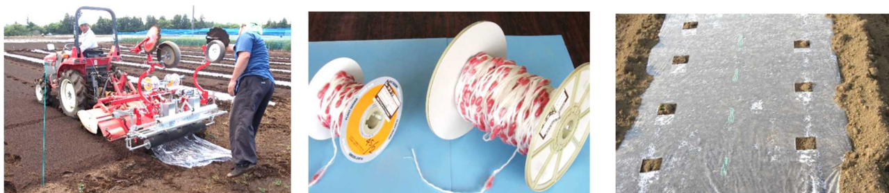
(トラクター装着の本機) (400m巻き大型リール<右>) (6cm角のフィルム開孔部)
