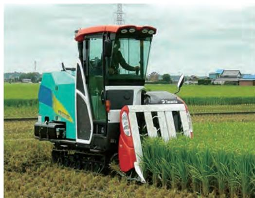
写真Ⅱ-6 コンバイン型専用収穫機
