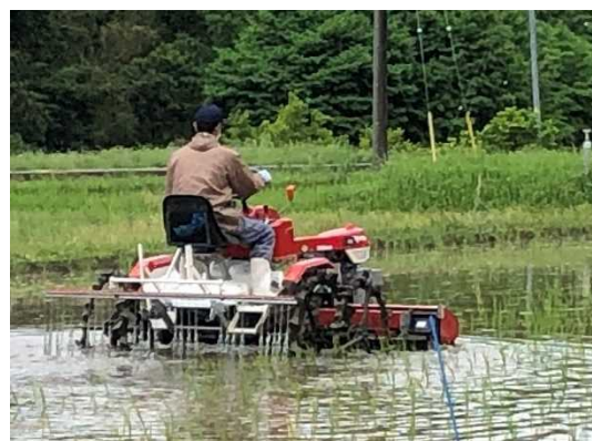
乗用型水田用除草機による作業
