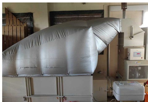
平型乾燥機の使用により、短時間で乾燥を終了し、カビの発生が少ない種子を確保
