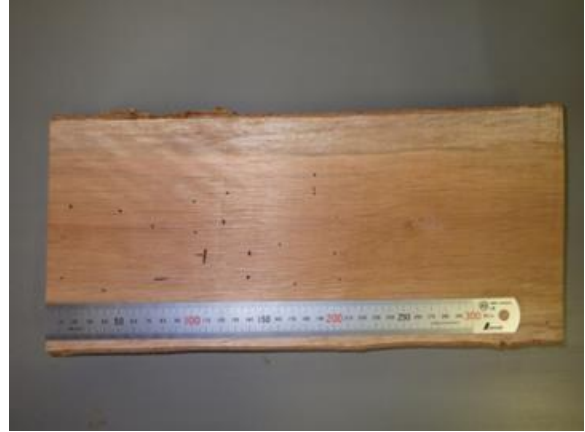
カシノナガキクイムシによる穿孔穴が生じているマテバシイ材
