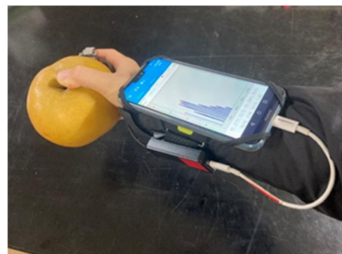
1点式振動硬度計によるみつ症判別の様子
