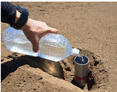
塩ビ管を用いた簡易調査法の設置
