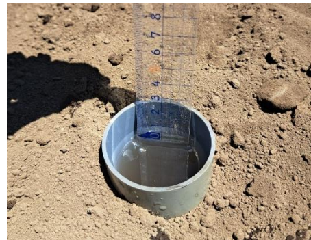
塩ビ管を用いた簡易調査法での減水深測定
