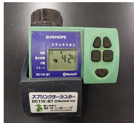
環境制御機器のプログラム機能付き電磁弁 (電池式かん水タイマー)
