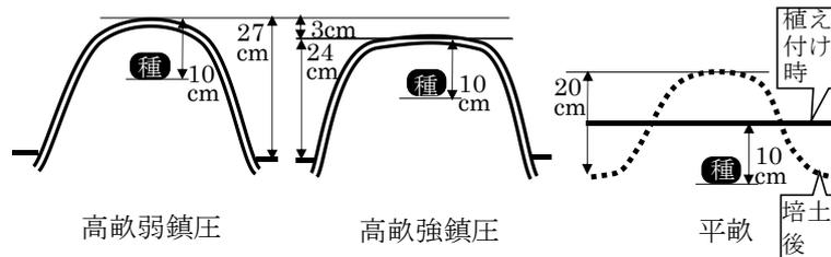
第1図 高畝弱鎮圧区, 高畝強鎮圧区及び平畝区の畝形状及び種芋の植付け位置
