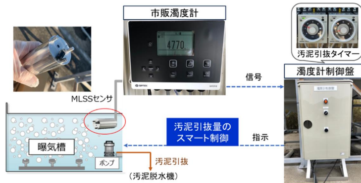
図3 スマート汚泥管理システムの概要
