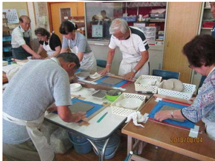
「たたら製法」での成形
