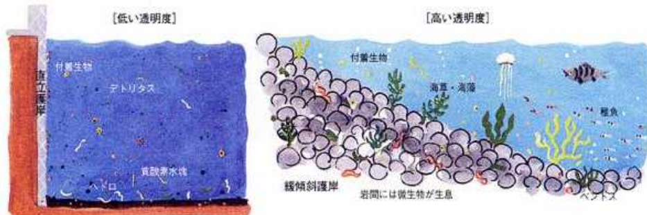
図 2-5-18 直立護岸と緩傾斜護岸（環境配慮型護岸）
