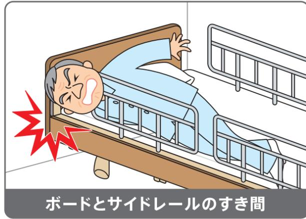
介護ベッドのJIS規格では、図のようにサイドレールとサイドレールのすき間に直径6cmの硬い円柱状の器具が入らないこととされています。
