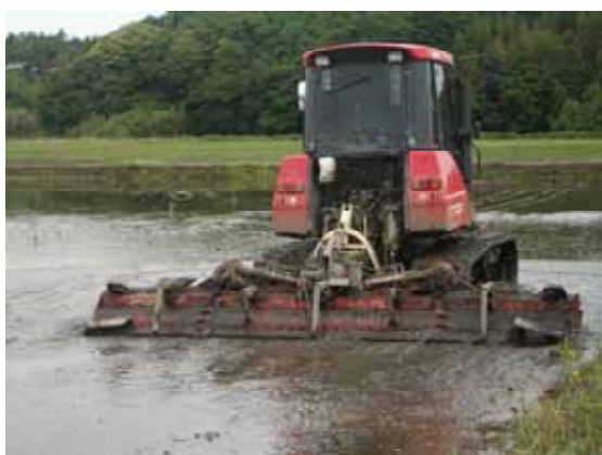
大型トラクタによる代かき
