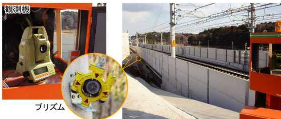
各工事において、変位計測機を設置し、鉄道構造物の変位を30分毎に観測しています。水平変位および鉛直変位の管理値を±3mmとし、管理値を超えた場合は、工事を一時中止し、原因確認を行います。
