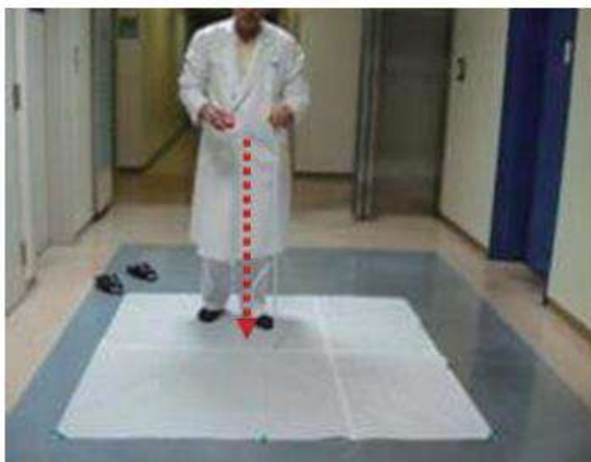
写真1 模擬おう吐物(A)の落下実験
