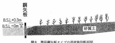
図 8 簡易鋼矢板タイプの消波施設断面図。
