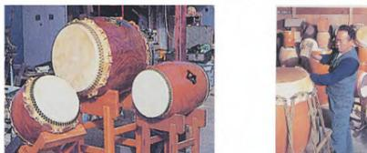
太鼓には、原材料である樺を原木のまま仕入れ、胴づくり、皮の加工、張り上げまでの工程があり、その大部分を手作業で行っています。
