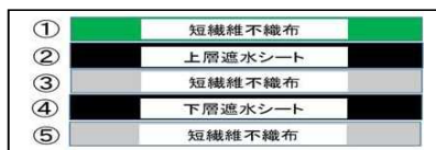
図-2 基準省令で定められる遮水工構造（5層構造）
