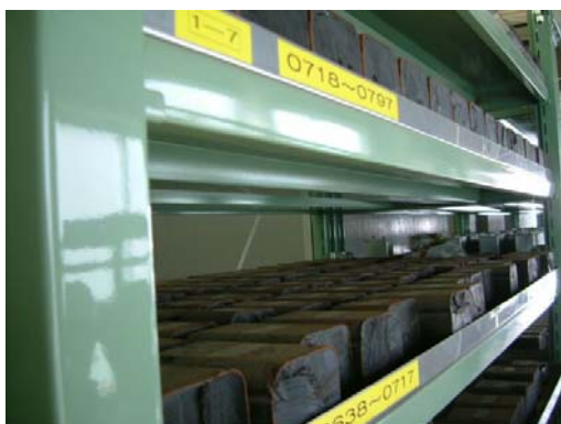
切断された廃安定器の保管例 (1)
