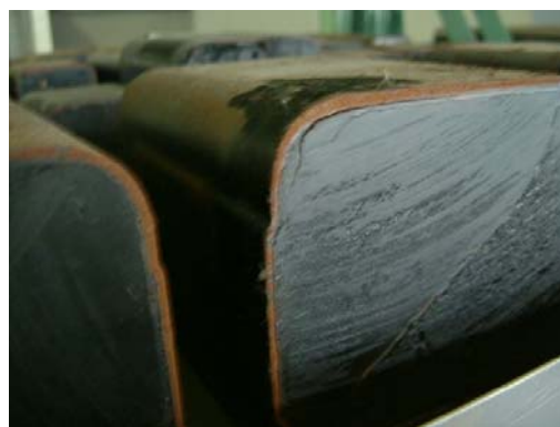
廃安定器の切断面
