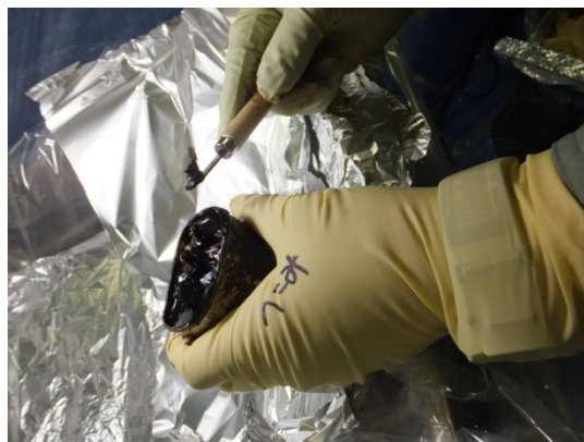
剥き身コンデンサ付着充填材の採取
