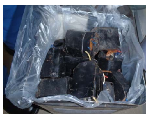
切断された廃安定器の保管例 (3)
