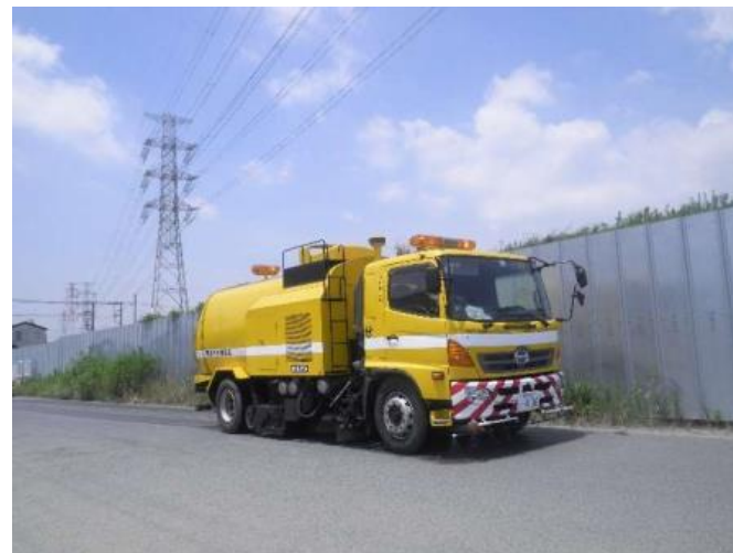
路面清掃車による清掃
