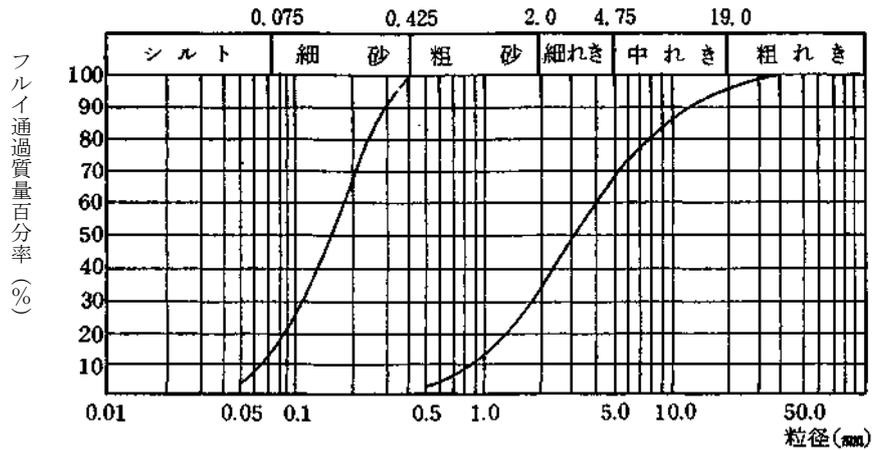
図 2 - 1 使用砂の粒径加積曲線
