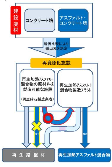
※1 アスファルト・コンクリート塊⇒再生路盤材 ※2 アスファルト・コンクリート塊⇒再生加熱アスファルト混合物 約20% ⇒ 0% 約80% ⇒ 100%
