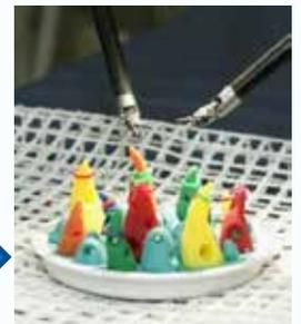
プログラasp（把持用）で直経6mm高さ1mmのリングを把持し、先端の曲がった筒に移動しています。鉗子の操作性が柔軟でリングを斜めや横から掛けるなど、微細な操作が可能です。
