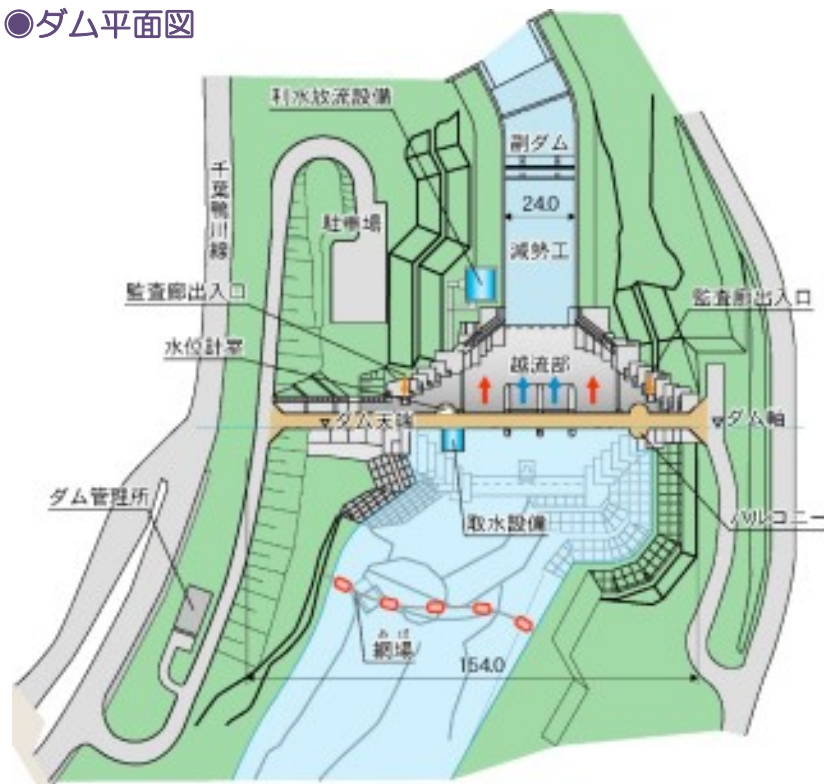
取水設備 貯水池から水を取り入れる設備
