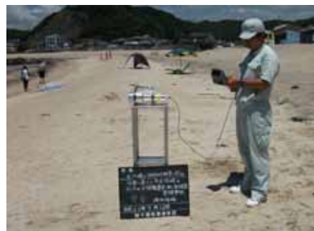
写真 3-8-6 砂浜の空間線量率の測定
