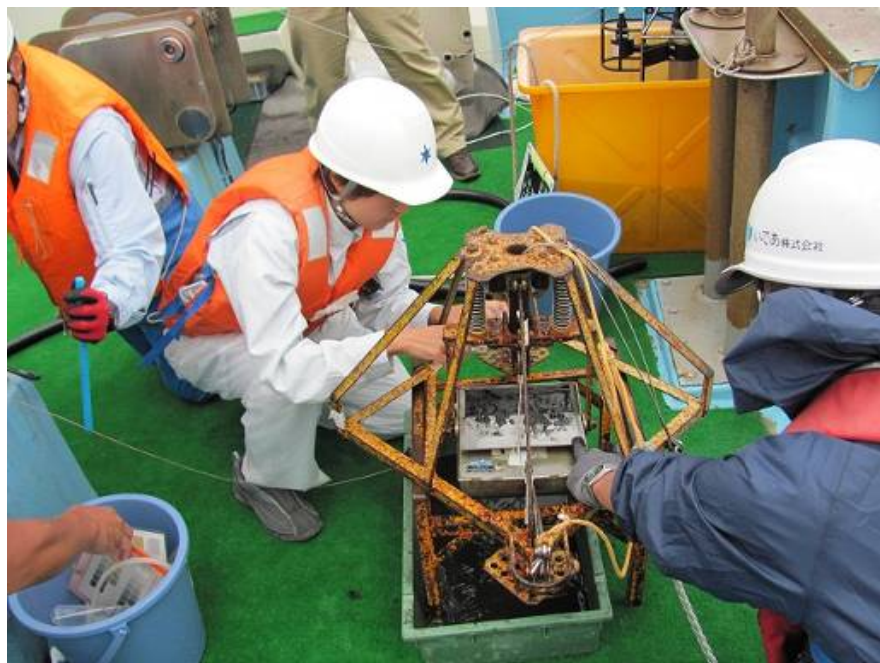
写真 3-8-7 東京湾の底質のサンプリング状況
