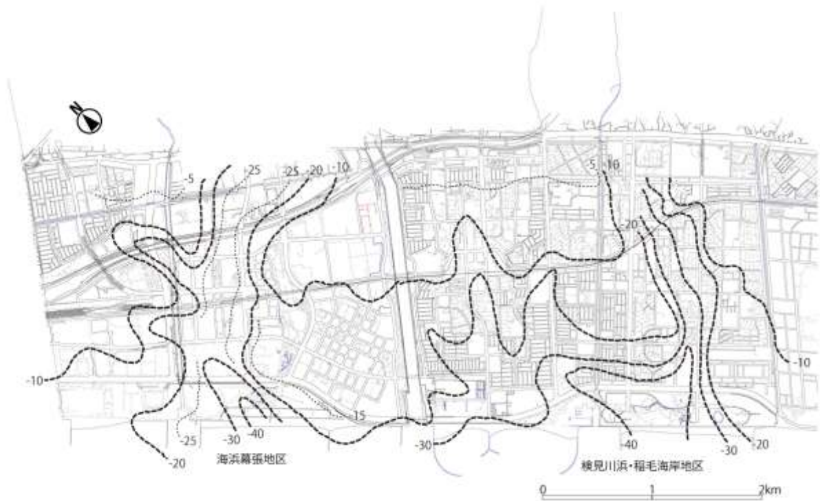
図 4.2-2(2) 沖積層下端深度コンター図（千葉県環境センターによる）
