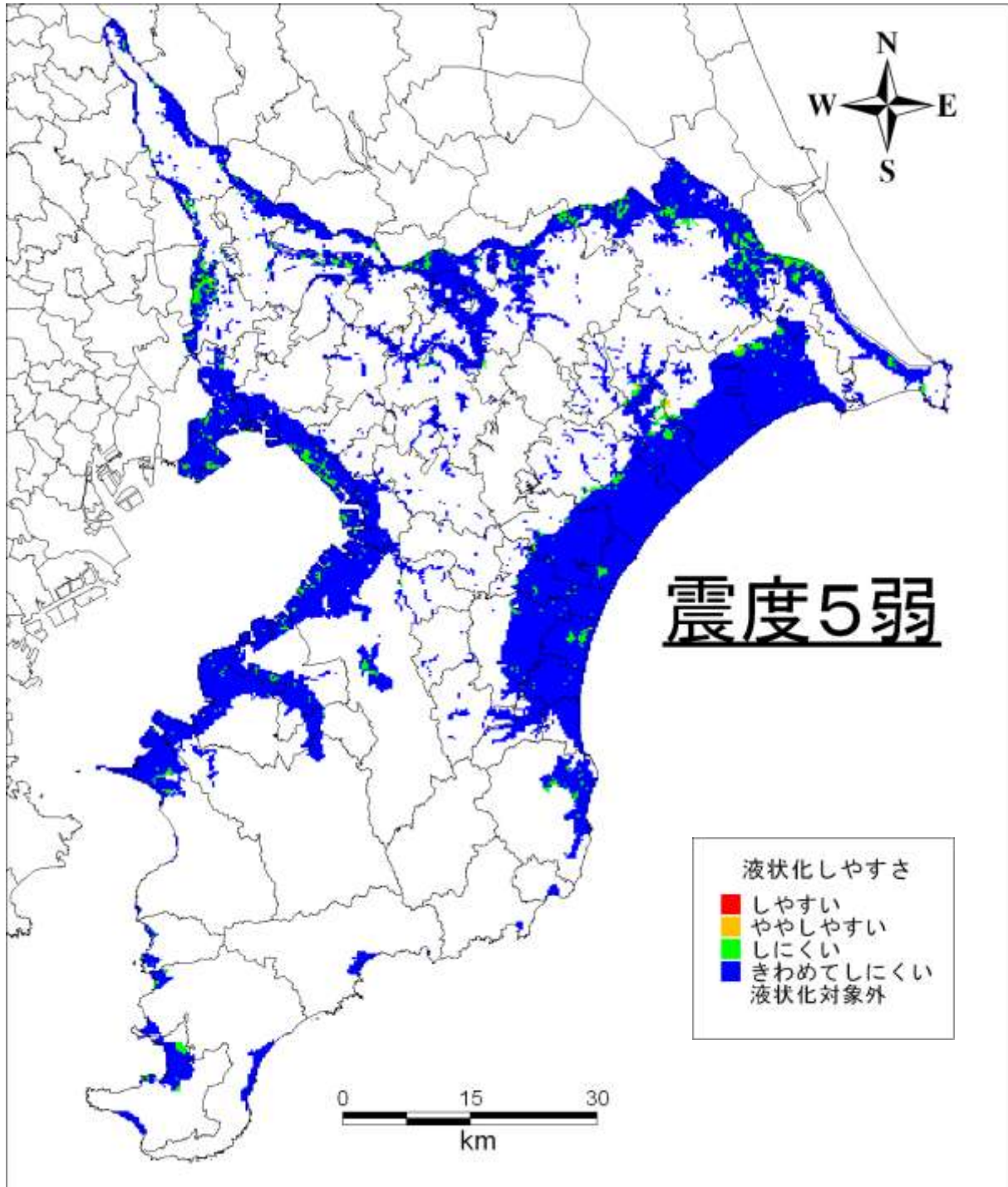
図 6.2-4(2) 液状化しやすさ試算結果 (通常継続時間地震・建築基礎・震度5弱・地表加速度170gal・全域)
