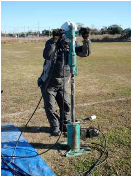
図 1.3-10 ポータブル表層土壌調査機（左図）、掘削部の先端はメタルビット（右図）
