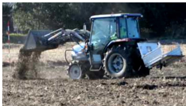
写真3 フロントローダー及び、トラクターダンプによる均平作業の様子
