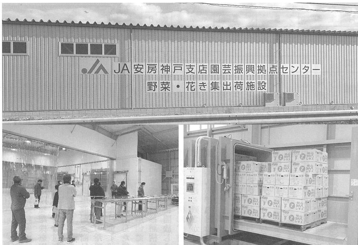
新たな集出荷施設の外観（上） 花きの集荷設備（左下）、レタスの真空予冷処理（右下）
